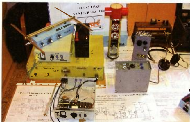
Obr. 3. Na výstavce si radioamatéři připomněli také radiový orientační běh, tzv. hon na lišku (ROB, ARDF). Milan, OK2VWF, připravil ukázkou zařízení určených pro tento oblíbený sport. Účastníci si tedy mohli prohlédnout dva vysíláče – Minifox 78 a Medvěd. Z přijímačů to byl první sériově vyráběný přijímač Junior, dále pak Delfin a ROB 80
