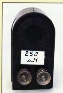
Obr. 7 a 8. Přípravky pro měření externích L a C
