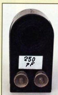
Obr. 7 a 8. Přípravky pro měření externích L a C
