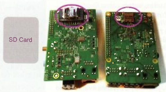
Změny v konstrukčním provedení počítače Raspberry Pi B+ oproti předchozí variantě Raspberry Pi B
