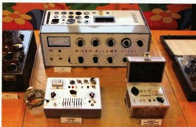
Obr. 4. Další část výstavky byla věnovaná měřícím přístrojům k měření a zkoušení elektronek. Nejstarším měřicím na výstavce byl přístroj WE 251 z r. 1938 od německého výrobce Josefa Neubergera. Na obrázku polský měřič P-508 (nahore), vlevo německý Euratele II a amatérsky zkonstruovaný cestovní zkoušeč nožičkových elektronek Lamptest (vpravo)
