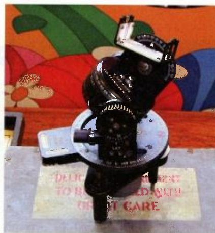
Obr. 2. Pozornost poutaly dva zajímavé přístroje: Letecký astrokompas MK II (na obrázku) a Bubble sextant Mark IX, které sloužily k určování azimutu pomocí Slunce a hvězd. Používaly je anglické i americké bombardéry během druhé světové války
